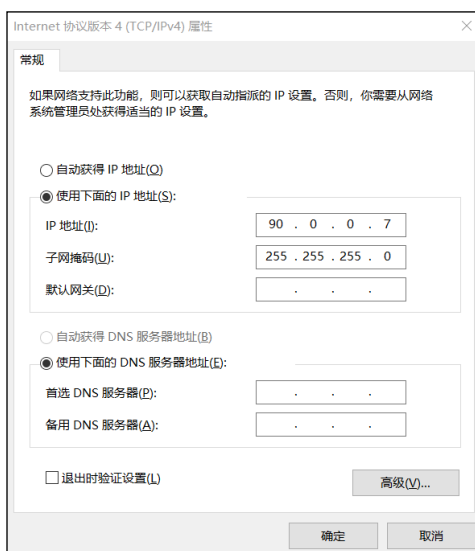
图 2-3 与控制器连接的 PC 网络设置
