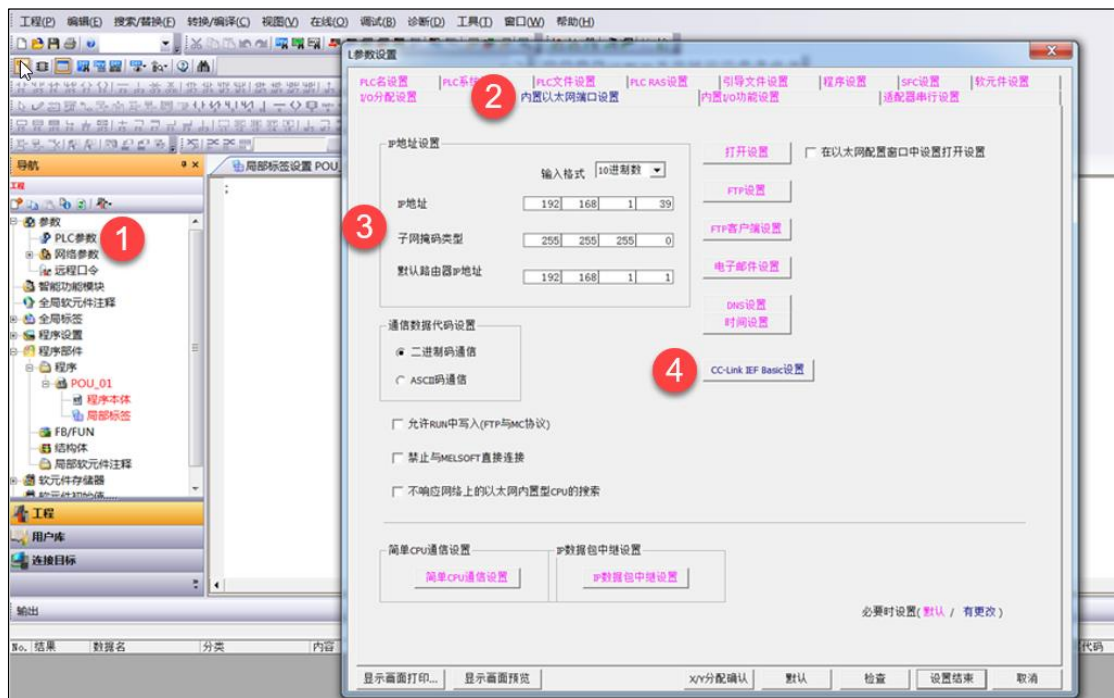
图 5-3-3 设置 PLC 的 IP 地址以及子掩码
